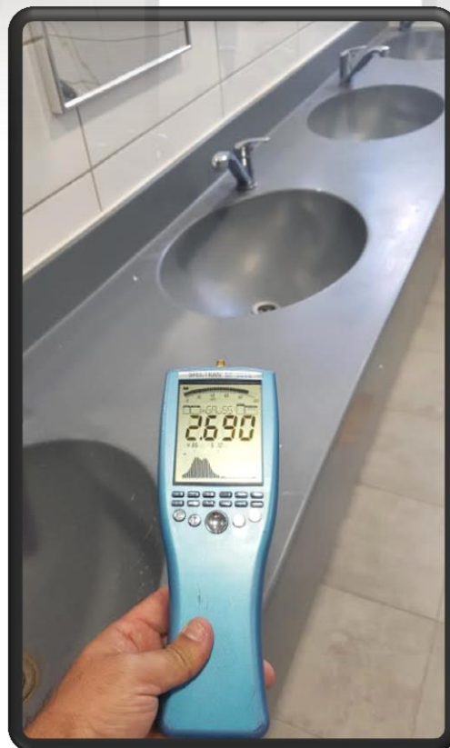
תמונה 3: הערך המתקבל בגב לוח חשמל משני קומה-א' בשירותים
