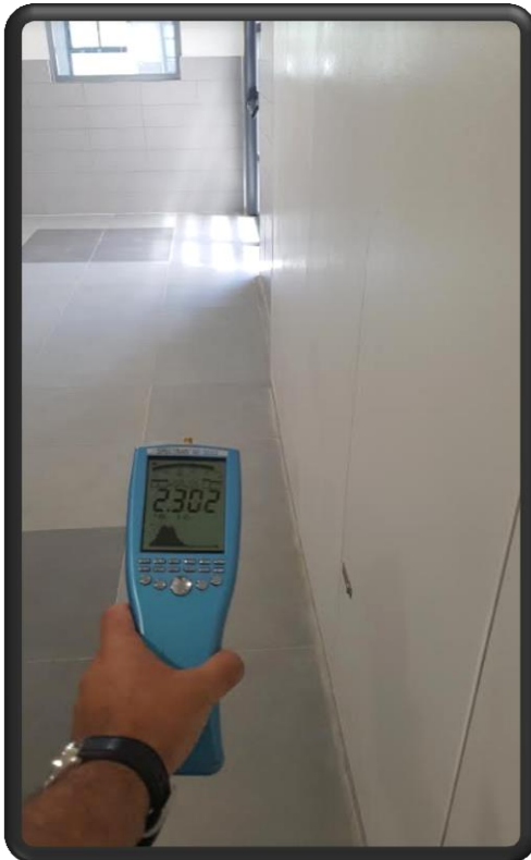
תמונה 3: הערך המתקבל בגב לוח חשמל משני קומה-א' בשירותים
